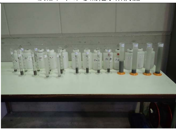
底質流動調査の沈降量測定 (1 昼夜)
