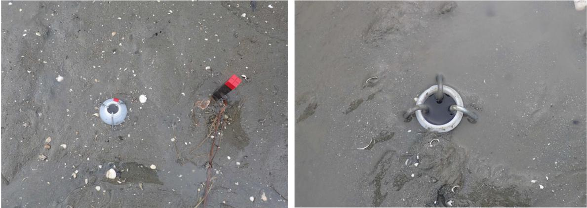
図-2.3 捕砂ビンの埋設状況
