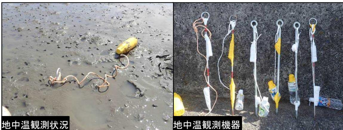
図-2.6 地中温度計測装置と設置状況の写真
