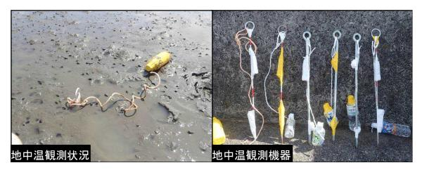
図-2.6 地中温度計測装置と設置状況の写真
