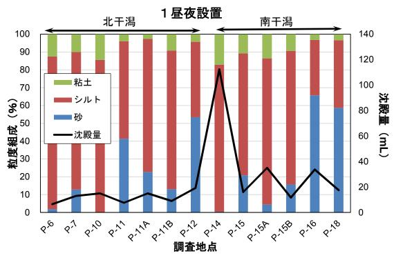
図-3.27 捕砂した底質沈殿量と粒度組成(1昼夜設置)
