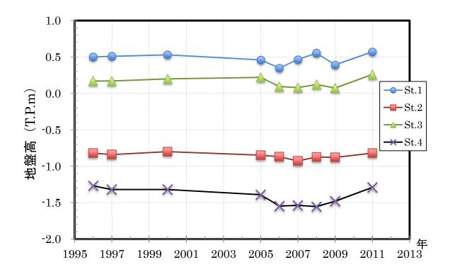
図-3.18 底質・底生生物調査の測点における地盤高の経年変化
