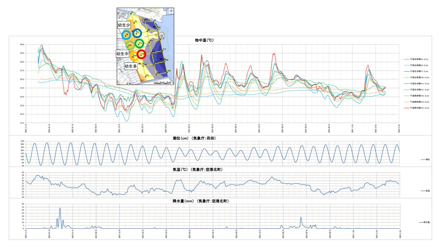
図-3.33 地中温度およびその他気象・海象条件の経時変化
