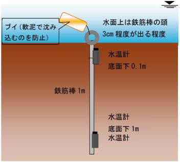
図-2.5 地中温度計測装置
