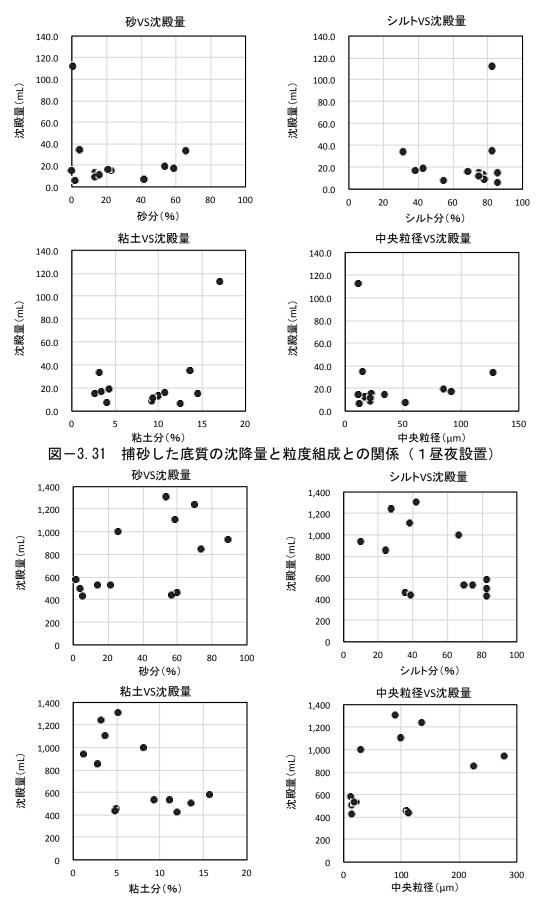
図-3.32 捕砂した底質の沈降量と粒度組成との関係(2週間設置)
