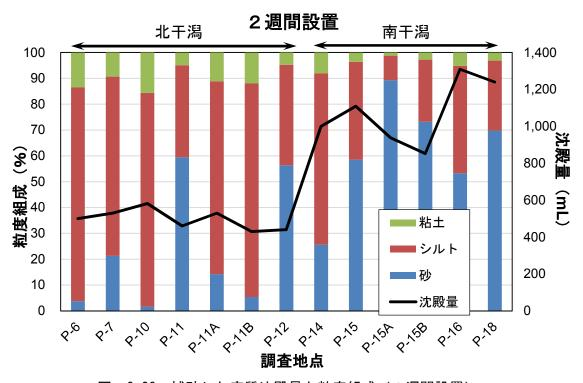
図-3.28 捕砂した底質沈殿量と粒度組成(2週間設置)
