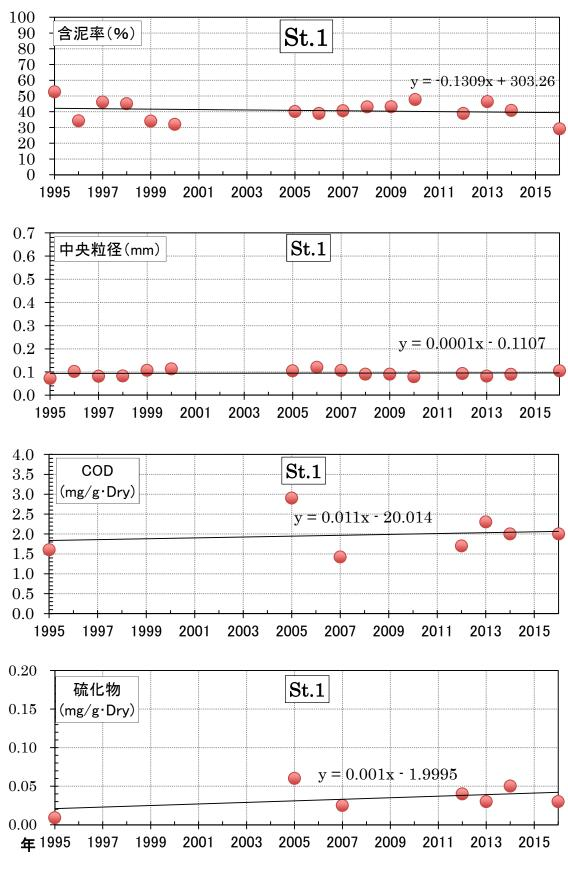
図-3.19 St.1における底質(含泥率,中央粒径,COD,硫化物)の経年変化
