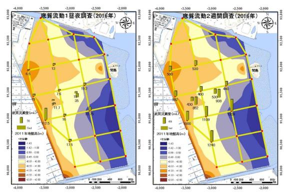
図-3.29 捕砂した底質の沈殿量(左図:1昼夜設置,右図:2週間設置)
