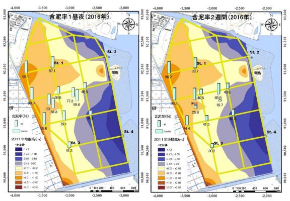
図-3.30 捕砂した底質の含泥率(左図:1昼夜設置,右図:2週間設置)
