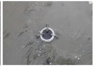
図-2.3 捕砂ビンの埋設状況
