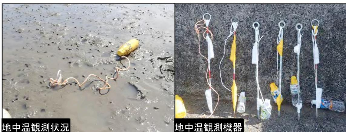
図-2.4 地中温度計測装置と設置状況の写真
