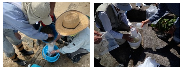
写真 7.4.2 採取した試料からプラスチックを比重選別法で分離している様子
