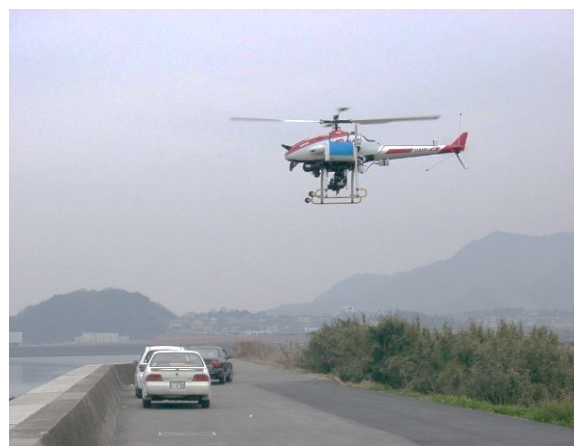
写真 8.2.5 RCヘリによる干潟写真の撮影状況
