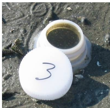
写真 4.4.4 曾根干潟における漂砂量調査(埋設状況)
